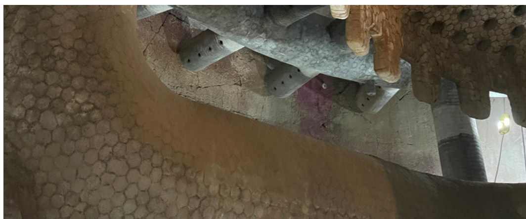
リジェネレーター、非コーキング環境では、厚い層の触媒の堆積が見られます。
