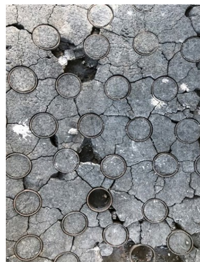
部分的に欠落したライニング
