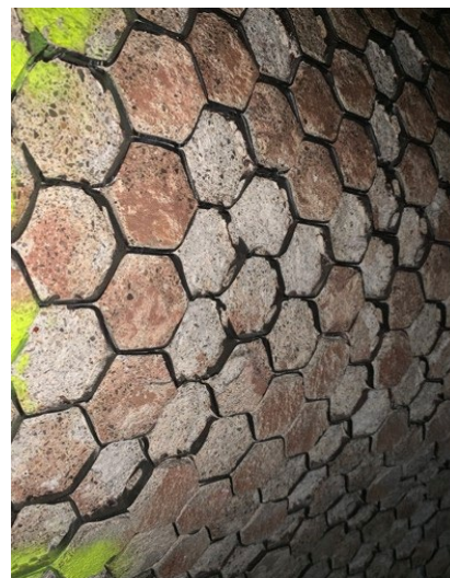
耐火材のはがれ落ちを「ビスケティング」と呼びます
