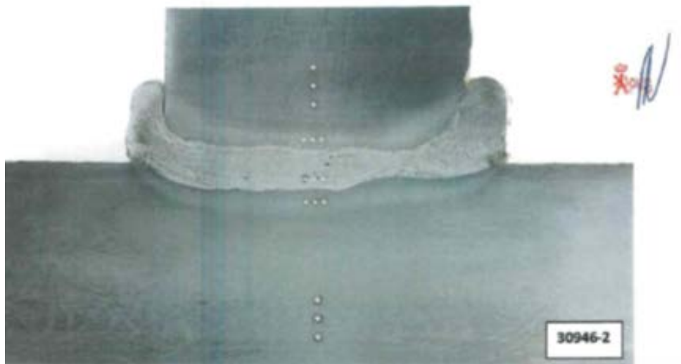
Figure 8. Soudage à l'arc rapide - Fixation d'un goujon en moins de 0,5 secondes.
