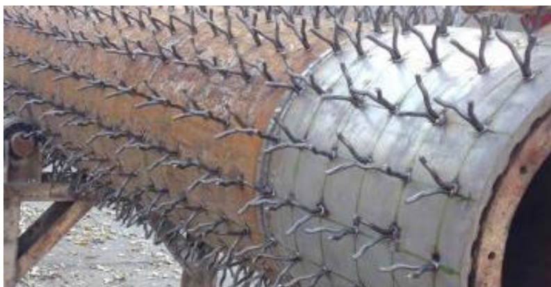
Fig 4. Installation d'ancrages en V sur une tuyère
