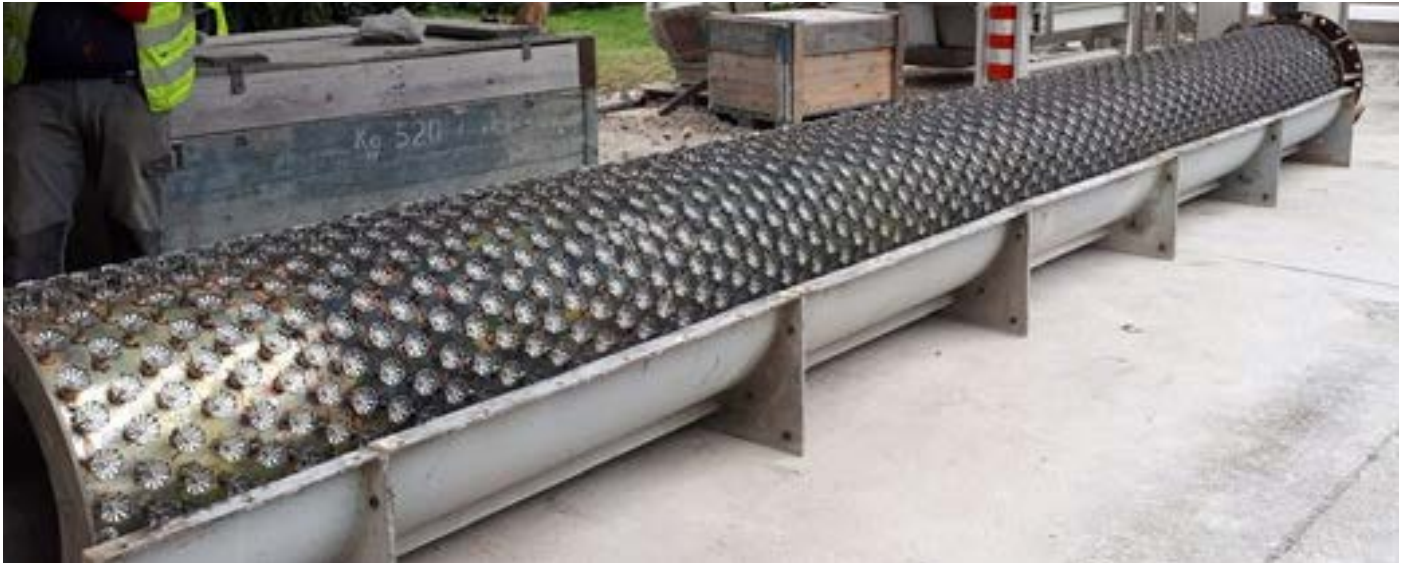
Figure 10. Une tuyère entièrement soudée avec des Speed Cells® prête pour la coulée du réfractaire.
