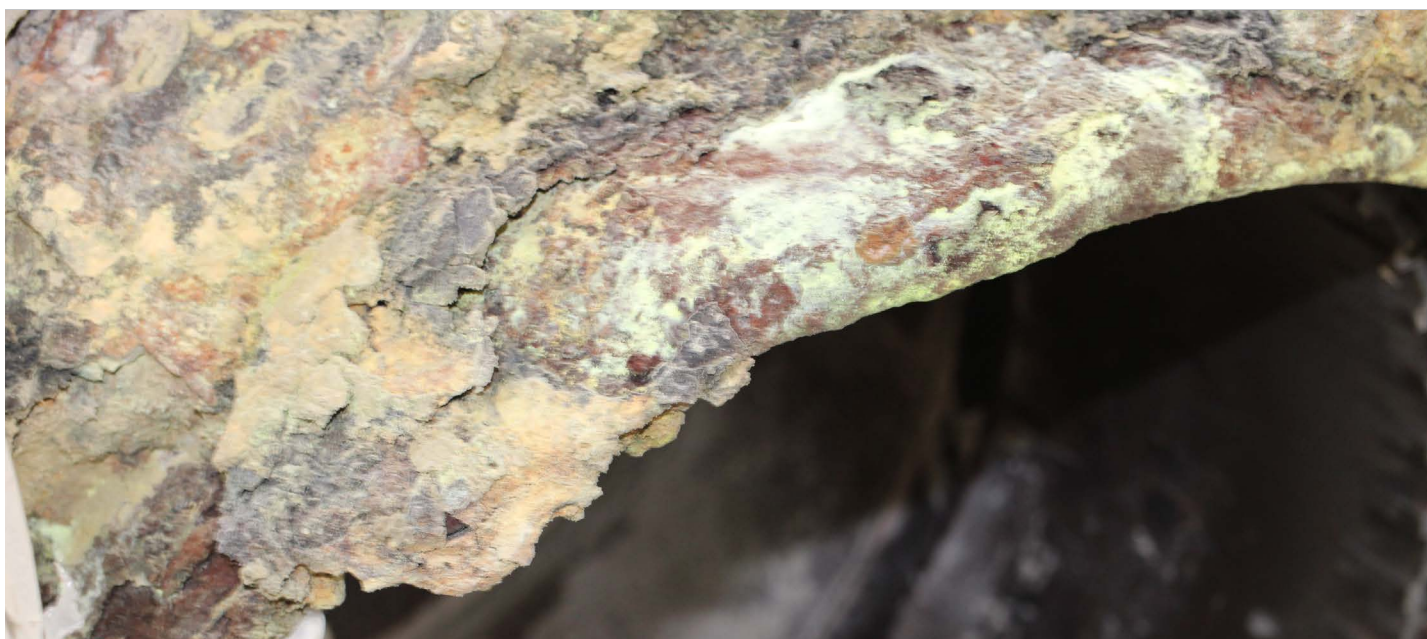
Figure 1. Erosion totale du revêtement côté tuyère. Les ancrages ont disparu.
