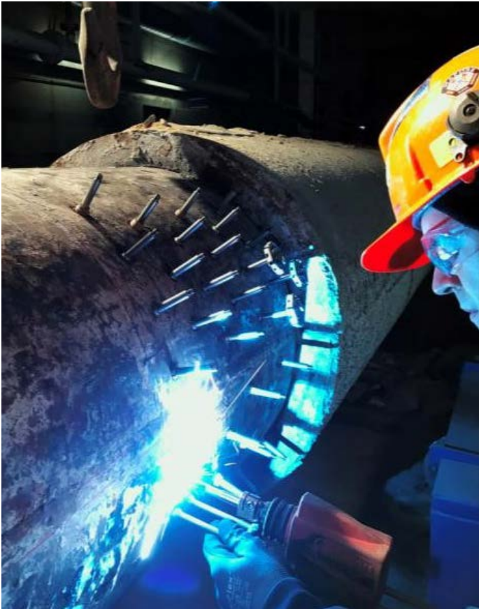
Figure 8. Soudage à l'arc rapide - Fixation d'un goujon en moins de 0,5 secondes.
