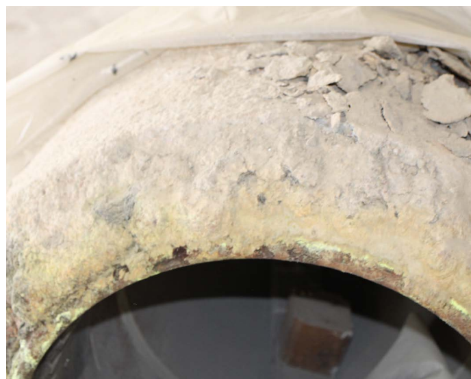
Figure 7. On peut voir que le système SpeedCell® a la capacité de maintenir le réfractaire uniformément pendant le fonctionnement, et d'absorber les vibrations.
