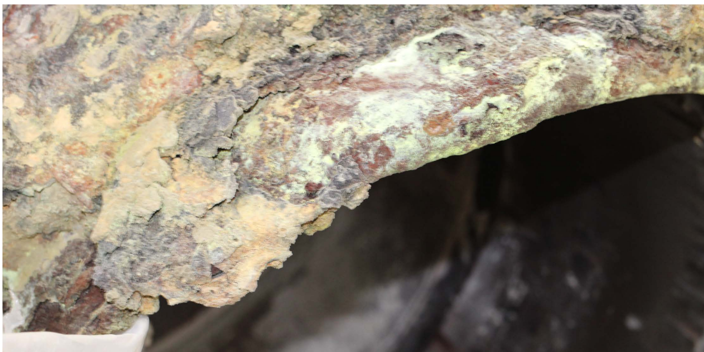
Figure 1. バーナー端部のライニングが完全に侵食され、アンカーは消滅している。
