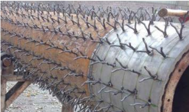
Figure 4: 典型的なVアンカーが施工されたバーナーパイプ
